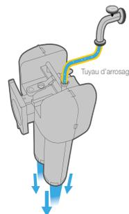
Connexion directe avec raccord (20x27) pour tuyau d'arrosage
